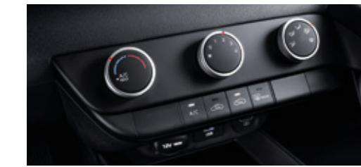
Manual Air Conditioner مكيف هواء يدوي
